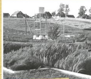
ВНИГЛ. Общий вид установки испарителей с болотной растительностью
